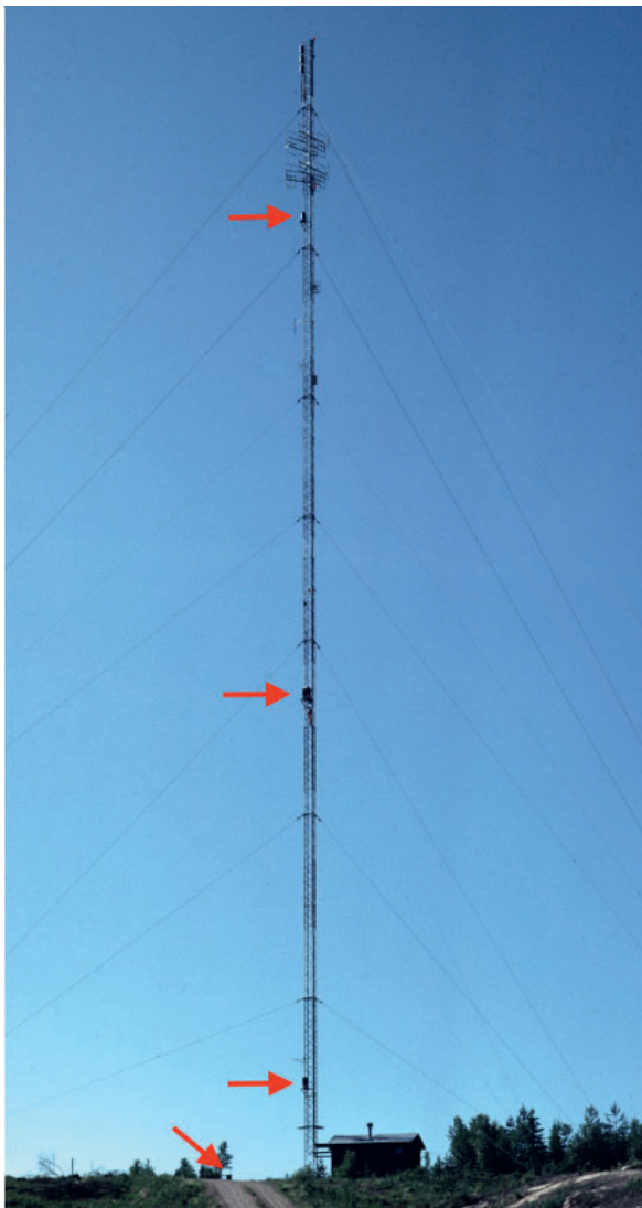
Figur 1. TV-masten på Ennarbolshammaren med de fyra sugfällorna med öppningarna på 2, 9, 43 och 93 m höjd över marken.
